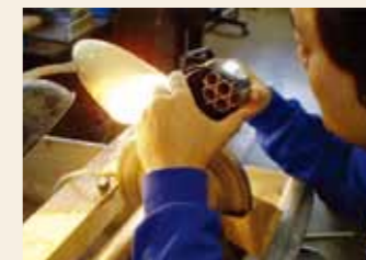
工藝師以不同粗細的鑽石砂輪進行圖紋的切割，在使用鑽石砂輪時，要怎樣調整玻璃的角度、如何施力，都需要相當熟練的技巧。
