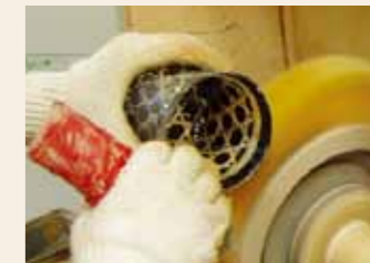
最後步驟的「石磨」，打磨時要非常小心謹慎，讓玻璃恢復原有的透明感。
