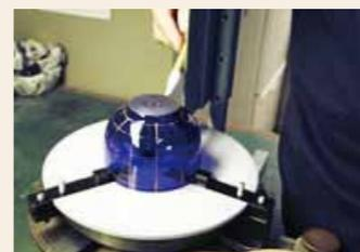
切子的製作開始只能在玻璃表面先作記號，預設圖案的位置，沒有底稿，圖案的繪製全憑工匠的技藝。
