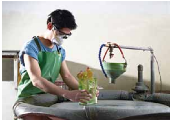
沁東為作品過粗鐵盤，把切完餘料的底部磨平，定出作品的水平。
