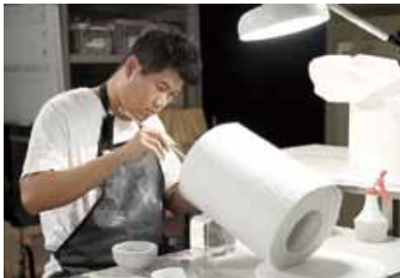
小安手裡拿著他自己做的工具，正一筆一筆將琉璃粉料填入耐火石膏模中。
