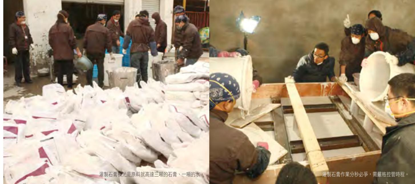
灌製石膏模光是原料就高達三噸的石膏、一噸的水。
