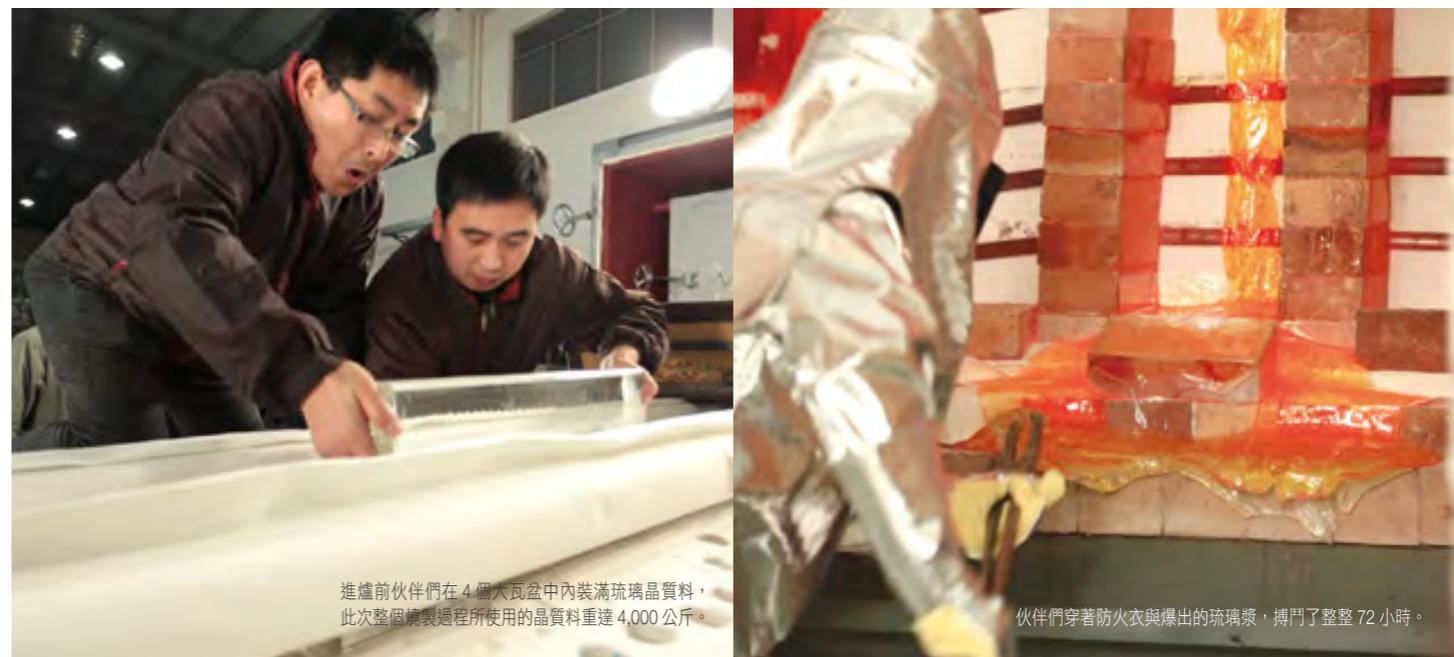
進爐前伙伴們在4個大瓦盆內裝滿琉璃晶質料，此次整個燒製過程所使用的晶質料重達4,000公斤。
